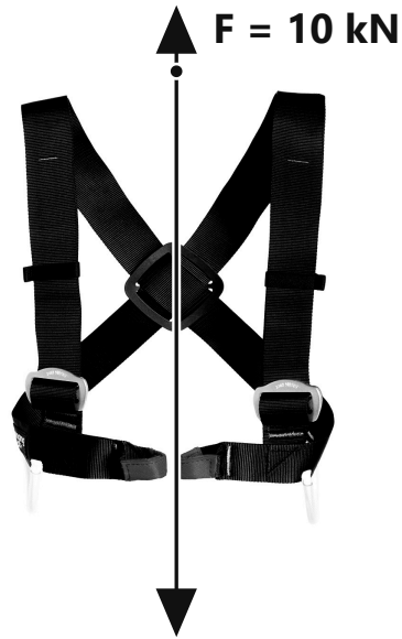
Tipo D (arnés de pecho): tracción con el muñeco en vertical, 10 kN; esquema sin escala.
