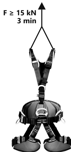
Fig. 1 – Ensayo estático: tracción F = 10 \times carga nominal (mín. 15 kN) durante 3 min en el punto de enganche de rescate (aquí, esquema sobre un SR EXPERT 3D speed; el punto real de cada modelo figura en su manual). Esquema sin escala.
