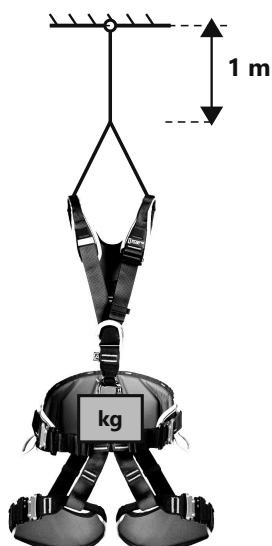
Fig. 2 – Ensayo dinámico: la masa de ensayo (kg) con el arnés cae 1 m hasta que la línea queda tensa; se repite una vez en menos de 15 min. Esquema sin escala.
