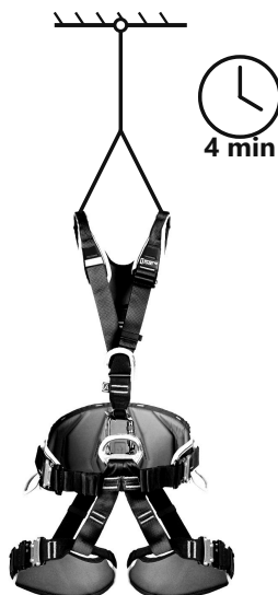
Fig. 3 – Ensayo de suspensión: la persona cuelga del punto de enganche hasta 4 min (reloj); a los 3,5 min se valora la comodidad. Esquema sin escala.
