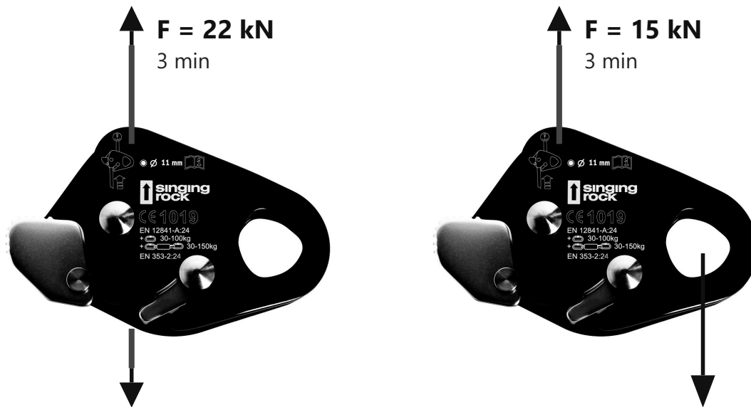
Fig. 1 – Resistencia estática: línea de anclaje textil con el anticaídas (izq., 22 kN) y anticaídas con elemento de amarre y conector (der., 15 kN), 3 min cada una. Esquema, no a escala.
