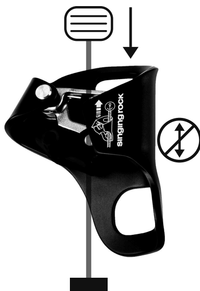
Fig. 3 – Ensayo de deslizamiento exigido además por UIAA 126: al cargar con la mano en el sentido normal, el bloqueador no debe resbalar por la cuerda. Esquema sin escala.
