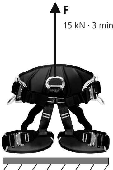
Fig. 1 – Resistencia estática: el arnés se tira por su punto de enganche delantero con F = 10 \times la carga máxima nominal (mín. 15 kN) durante 3 min, sujeto por las perneras. Esquema sin escala.
